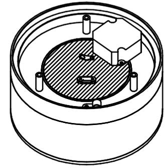
Steckverbindung zwischen Armatur und Driver lösen
