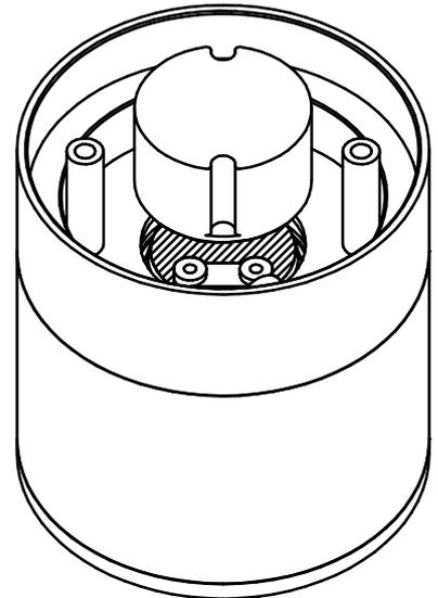
Steckverbindung und Halteseil zwischen Armatur und Driver lösen
