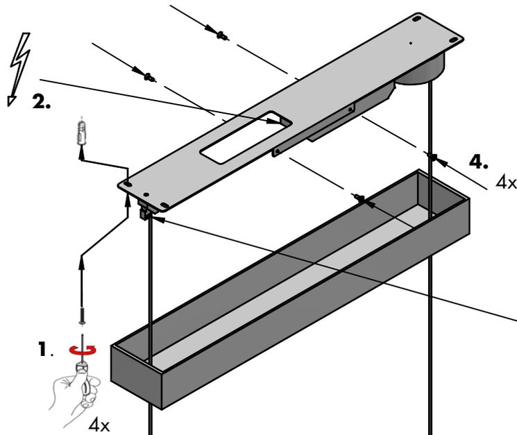
Die Leuchte ist werksseitig ausgerichtet, zum Nachjustieren diese Schraube betätigen.
